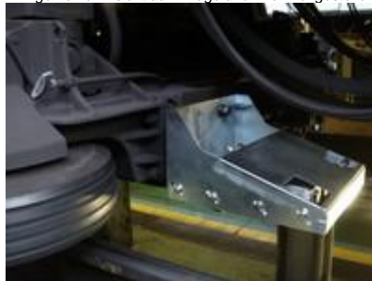
Prototyp der Antenne DOF1-Bord am Drehgestell angebracht
